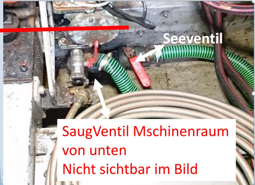
Hinweis, zum Bilgenauspumpen im Schiff
