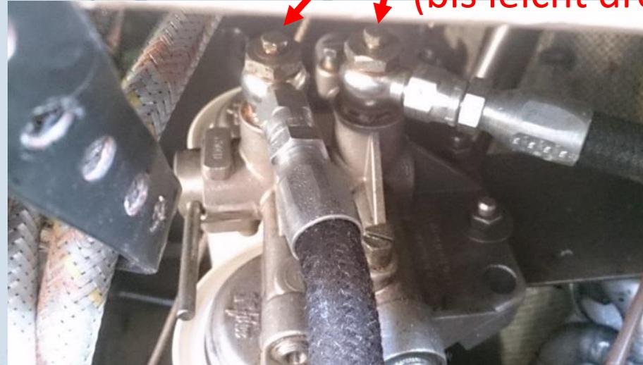
Lösen der M6 Schrauben
